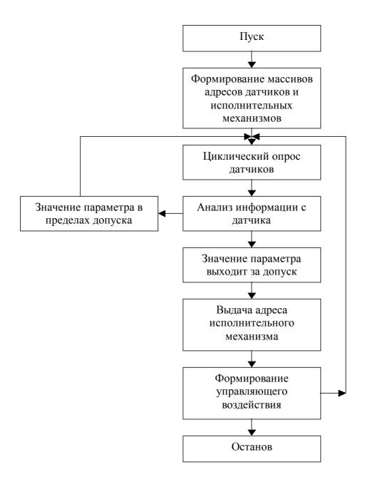
Рис. 3.1. Алгоритм программы управления параметрами
