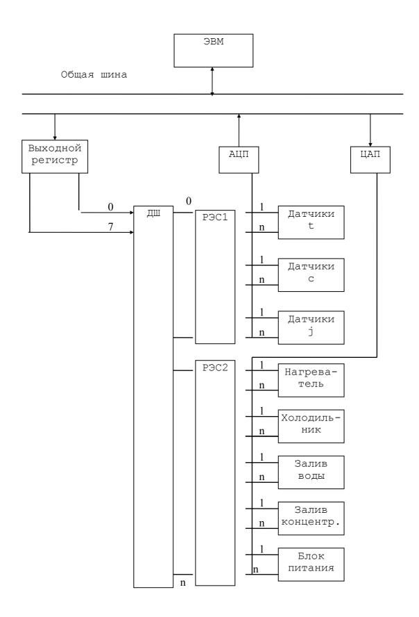
Рис. 3.3. Схема АСУ участка гальванопокрытия
