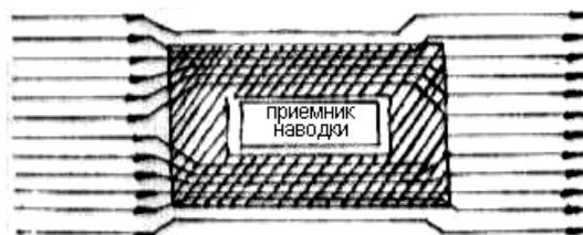
Рис.3.6. Силовые линии магнитного поля в шунтирующем экране
