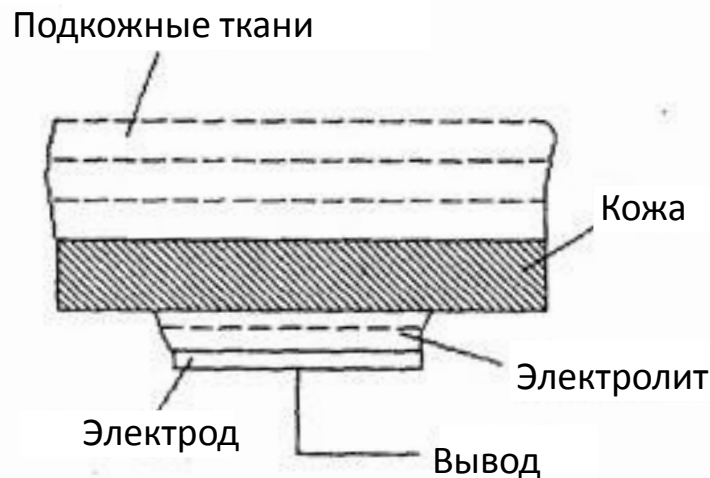
Рис. 3.18. Структура участка контакта электрода с кожей
